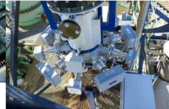
レーザー式ガス濃度計測装置
