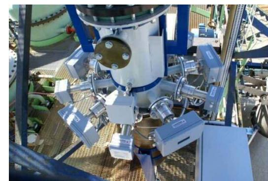
レーザー式ガス濃度計測装置
