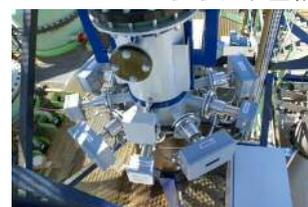
レーザー式ガス濃度計測装置
