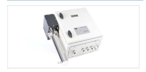
LaserGas II MPは、近赤外線単線吸収分光法(TDLAS)という原理を採用しており、サンプリングタイプの分析計です。 ppmからppbレベルまでの、より低濃度のガスをリアルタイムに測定することができます。
