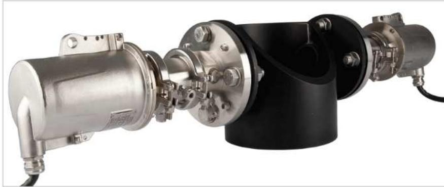
LaserGasIII SPは、ダクト直付けの対向タイプです。防爆エリアでの測定用に特別に設計されており、zone1のエリアでもご使用いただけます。応答速度は約2秒以内となり、プロセス管理などのリアルタイム測定で活用できます。本分析計は、計器に接ガスすることなく測定する為、有毒・腐食性ガスや高温・高ダスト等、通常、他計器では測定が困難な環境下でも組成ガスの干渉を受けずに測定することが可能です。また、消耗品がなく、定期的な校正も必要ないため、スマート保安に適合しており、メンテナンスの手間並びにコストを大幅に削減することができます。
